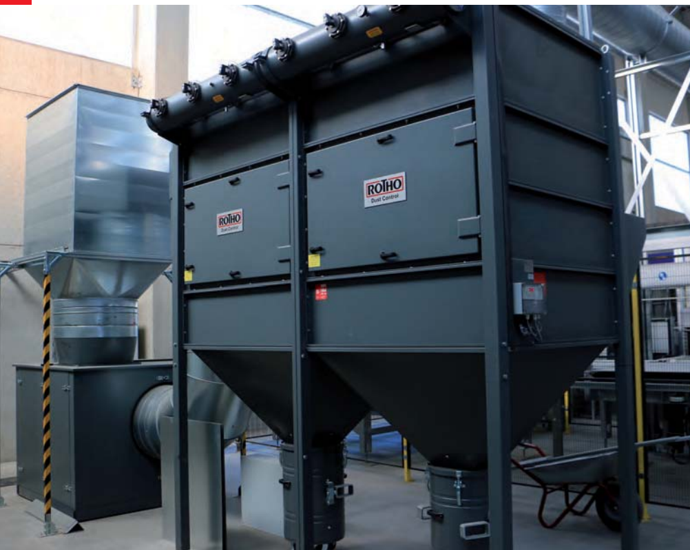
Filteraggregat mit automatischer Staubabrüttlung
